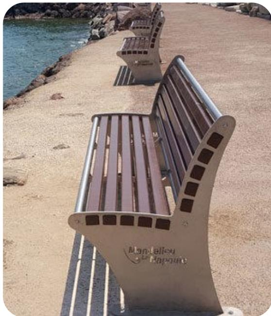
Le **Recyclène** est un matériau fabriqué à partir de plastique composite recyclé à base de polyéthylène issu de déchets industriels, agricoles et ménagers. Généralement destinés à être traités par incinération, ces déchets sont ici broyés pour obtenir un granulat exploitable. Puis, sous pression, ce granulat est fondu puis extrudé en profilé de finition compacte d'aspect thermo-laqué.
